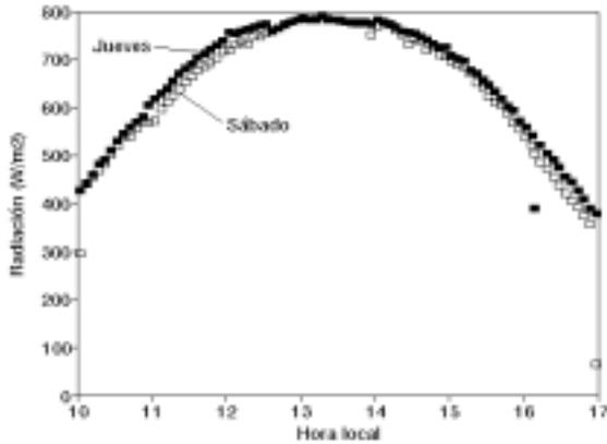
Figura 7: Radiación solar de dos días claros comparables.
