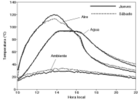
Figura 8: Calentamiento de cocina pesada con agua.
