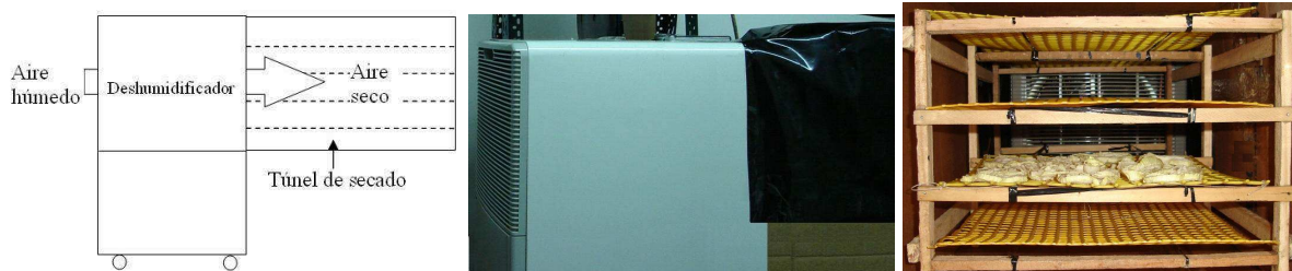
Figura 2: Secador de laboratorio con circulación forzada de aire, sin ingreso de radiación y detalle de las bandejas.
