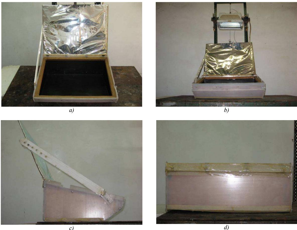
Figura 1: Cocina solar tipo caja usada: a) Vista superior frontal; b) Vista completa; c) Vista lateral y d) Vista fondo.
